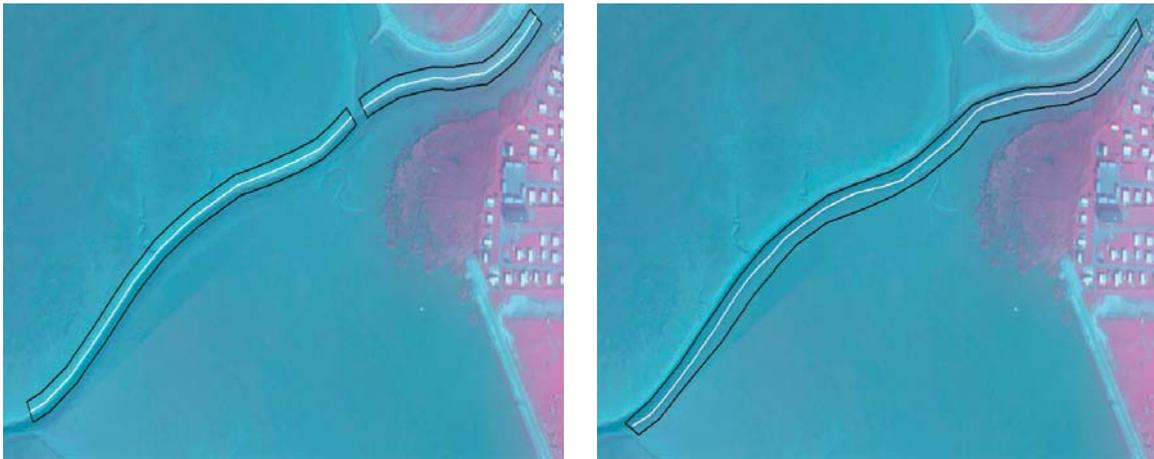
Abb. 18: Befliegung „Außenweser 2004“ – Näherungslösung sowie Umringspolygon für die nördliche (links) und südliche Böschung (rechts). Die Mittelachsen sind in weiß und die Umringe in schwarz dargestellt
