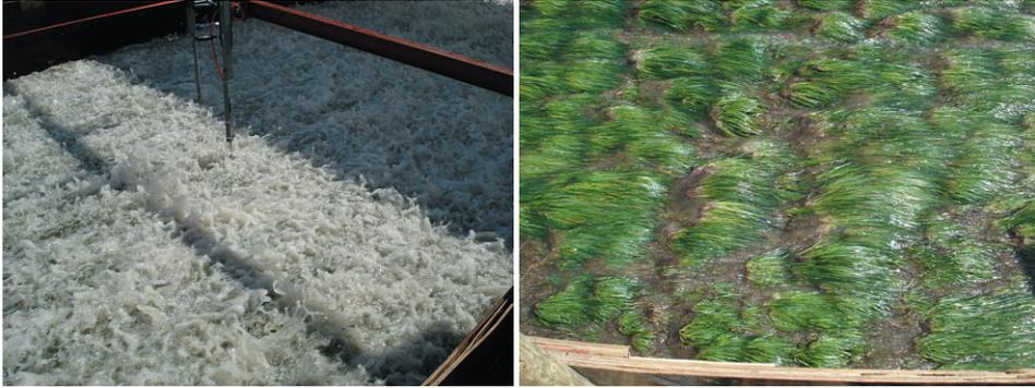
Abb. 1: Kleiabdeckung und Grasnarbe des Deichs in Delfzijl (hier bei 20 l/(s·m) mittlerer Wellenüberlaufate)
