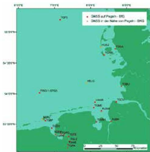
Abb. 4: Pegelstationen mit kontinuierlich arbeitenden GNSS-Systemen (Stand 04/2012)
