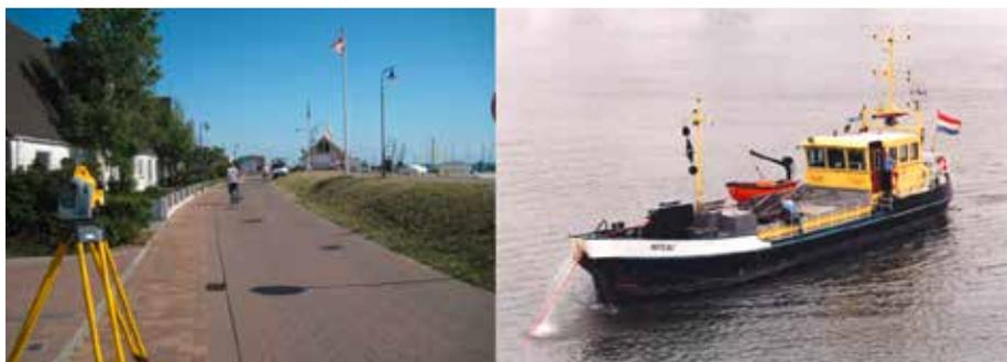
Abb. 3: Geometrisches und hydrostatisches Nivellement
