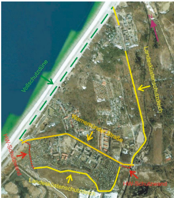
Abbildung 16: Hochwasserschutzanlagen um Markgrafenheide.
