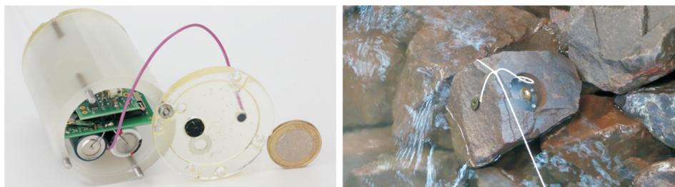
Abbildung 10: Beispiel eines Wasserbausteins mit Sensortechnologie.
