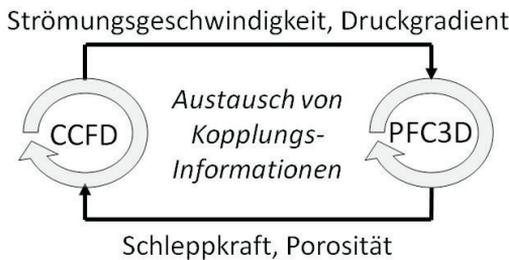
Abbildung 9: Berechnungszyklus gekoppelter DEM-CFD-Berechnungen.
