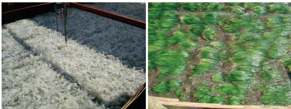
Abbildung 1: Binnenböschung eines Deichs in Delftzijl bei Wellenüberlaufversuchen in der Natur.
