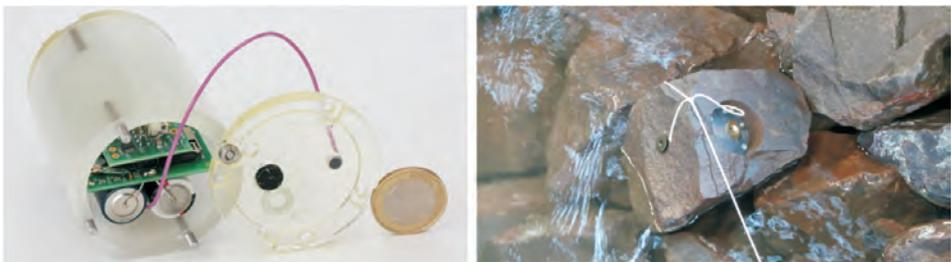
Abbildung 10: Beispiel eines Wasserbausteins mit Sensortechnologie.
