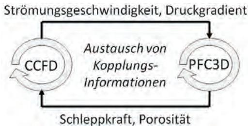
Abbildung 9: Berechnungszyklus gekoppelter DEM-CFD-Berechnungen.
