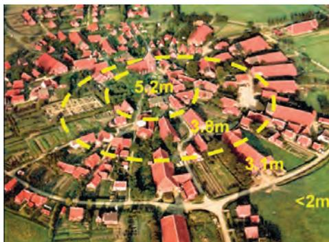
Abbildung 7: Rundwarftendorf Rysum in Ostfriesland. Die Markierungen stehen für Wasserstände oberhalb NHN. Der aktuelle Bemessungswasserstand liegt etwa 6,5 m über der Bezugshöhe (RITZMANN und NIEMEYER 2012).
