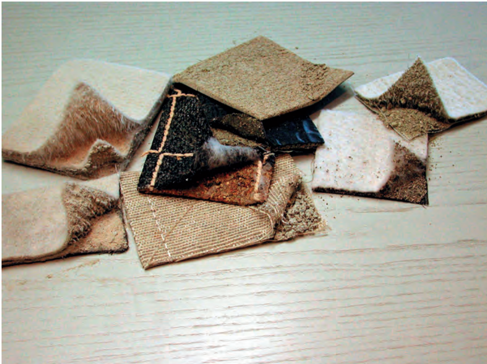
Abb. C 18: Verschiedene geosynthetische Tondichtungsbahnen (Bentonitmatten)
