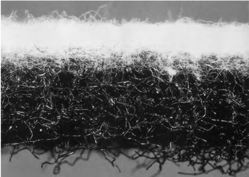
Abb. C 14: Detailaufnahme eines Vliesstoffes mit Stabilisierungsschicht
