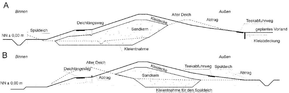
Abb. G 47 A + B: Deichverstärkung je nach verfügbarer Fläche:
