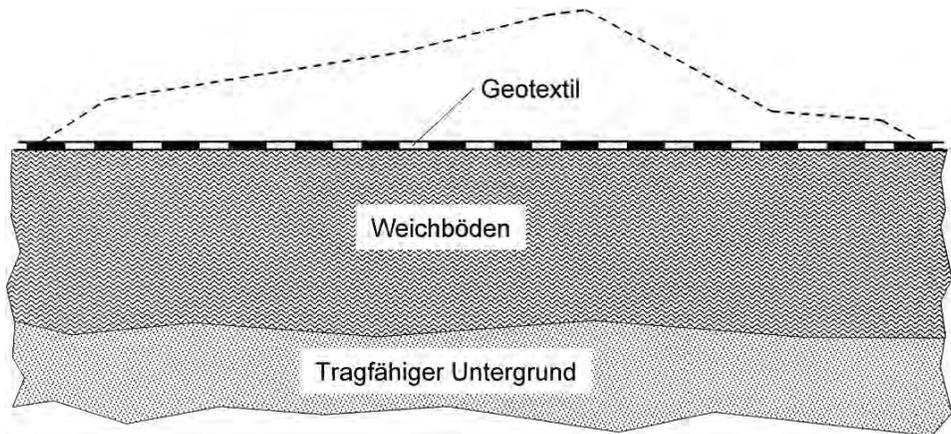
Abb. G 41: Geokunststoffe zur Bewehrung von Deichaufstandsflächen
