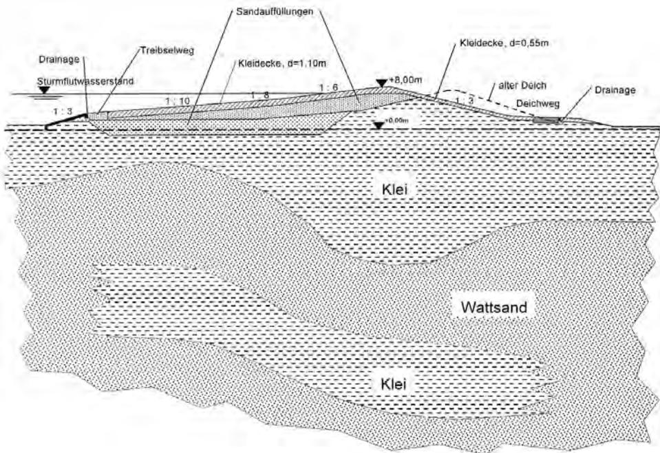
Abb. G 36: Beispiel einer Deichverstärkung Tümlauer Koog im Querschnitt
