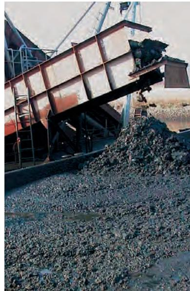
Abb. G 48a + b: Aufnahmegert für Baggergut mit Förderung in Schuten
