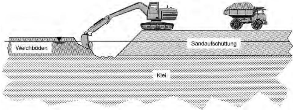
Abb. G 37: Räumung des Weichbodens durch Tieflöffelbagger
