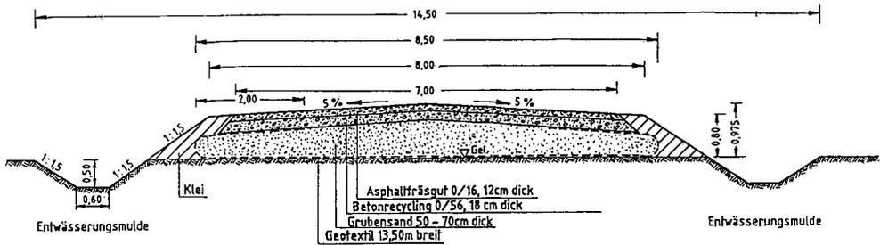
Abb. G 69: Querschnitt einer Baustraße in Nordfriesland unter Verwendung eines Kunststoff-Gewebes
