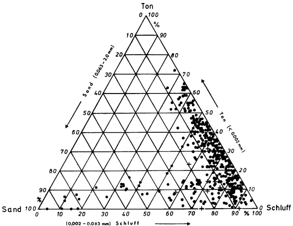
Abb. G 29: Dreiecksdiagramm der Korngrößenverteilung pleistozäner Beckenablagerungen
