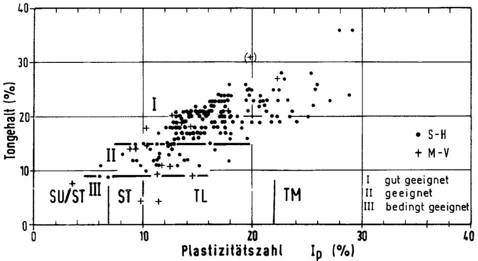
Abb. G. 28: Tongehalt vs. Plastizitätszahl bei Geschiebeböden
