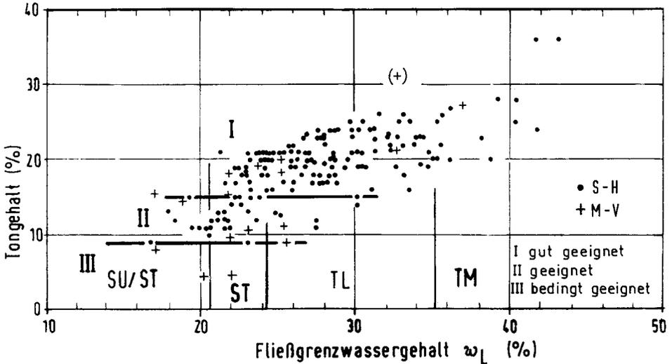
Abb. G 27: Tongehalt vs. Fließgrenze bei Geschiebeböden
