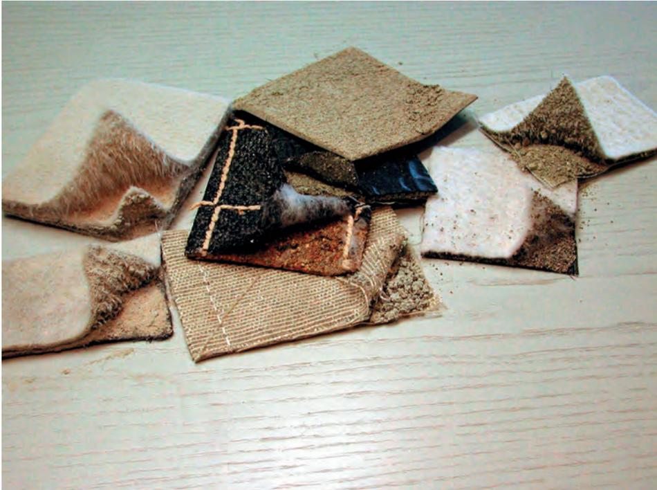
Abb. C 18: Verschiedene geosynthetische Tondichtungsbahnen (Bentonitmatten)
