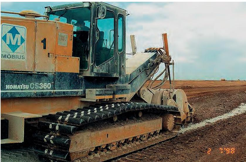
Abb. G 48h: Verbesserungsmaßnahmen durch Fräsen
