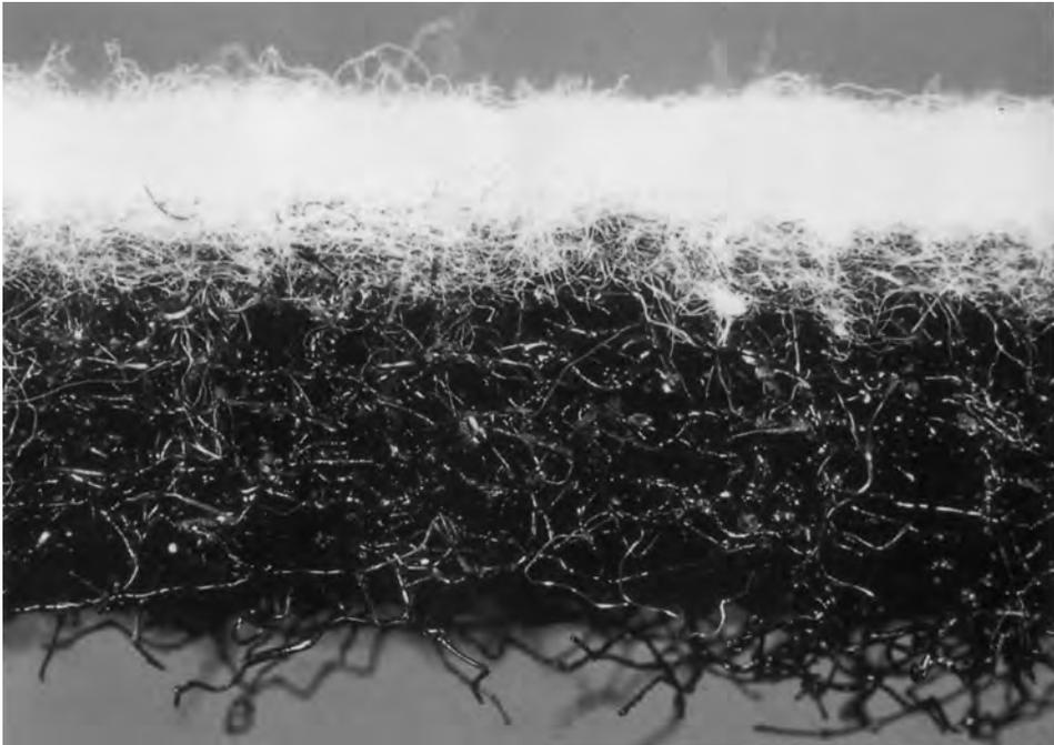
Abb. C 14: Detailaufnahme eines Vliesstoffes mit Stabilisierungsschicht
