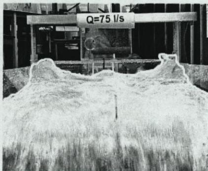
Abbildung 3: Tosbecken von Unterwasser mit eingezeichnetem Wasserspiegel
