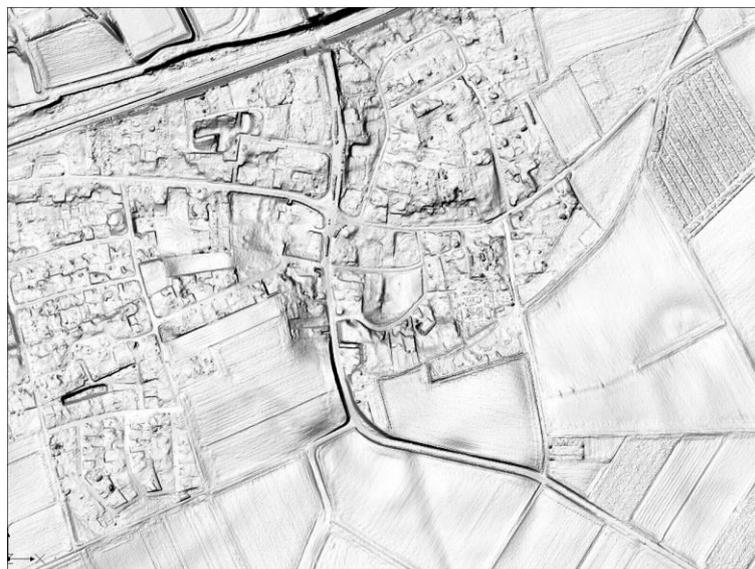
**Abbildung 2:** GIS-Analyse: Schummerung macht kleine abflussrelevante Strukturen sichtbar.
