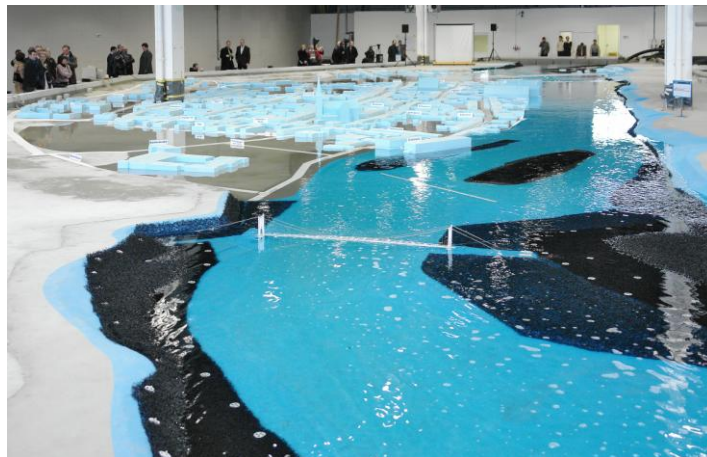
Abbildung 5 Physikalischer Modellversuch im Maßstab 1:50 [K. Eckhold, TU Dresden]
