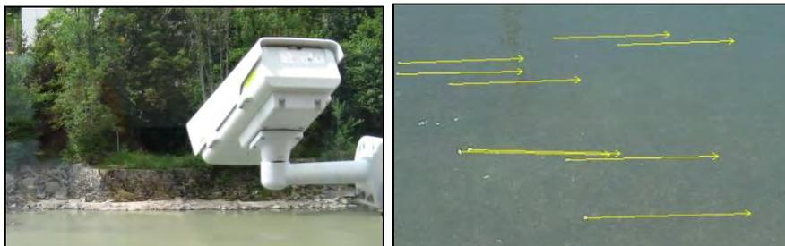
**Abbildung 12:** Video Hydrometrie mit einer Netzwerkkamera und Beispiel für die Teilchenverfolgung an der Wasseroberfläche (Foto rechts: Tenevia)
