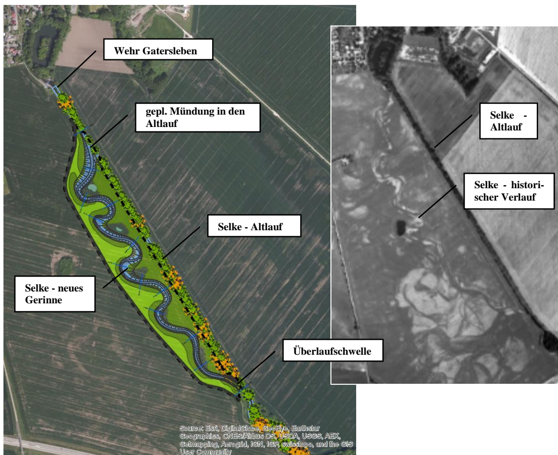
Abbildung 1: Links: Planung mit neuem, gewundenem Gewässerlauf, variierenden Gerinnebreiten, Auwald (dunkelgrün) und Flachland-Mähwiese (hellgrün), Rechts: historischer, verfüllter Gewässerlauf in der linken Aue sichtbar, welcher auf Grund der Notwendigkeit zur Minimierung der Flächeninanspruchnahme nicht vollständig revitalisiert werden konnte
