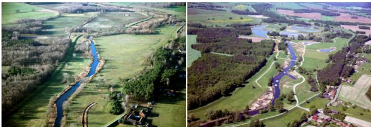
Abbildung 1: Spreeabschnitt bei Maiberg vor der Renaturierung sowie 1,5 Jahre später nach Maßnahmenumsetzung (Quelle: Vattenfall)
