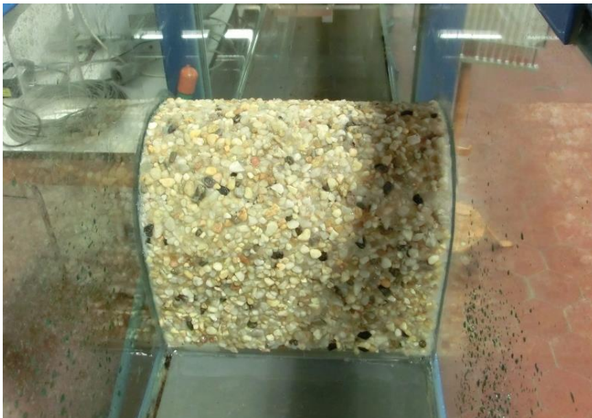
Abbildung 4 Beschichtung eines Modellwehres Sandkorn k = 5 mm
