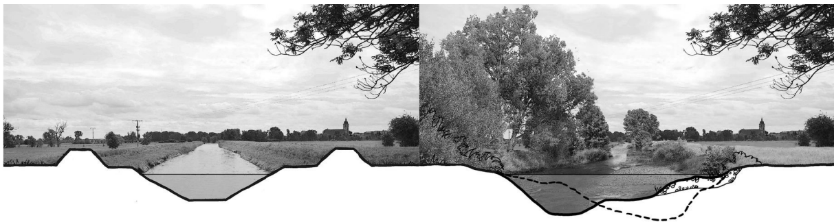
Abbildung 6: Heutiger (links) und vorgeschlagener Gewässerquerschnitt, Quelle: Büro f. Grün- und Landschaftsplanung Mihla
