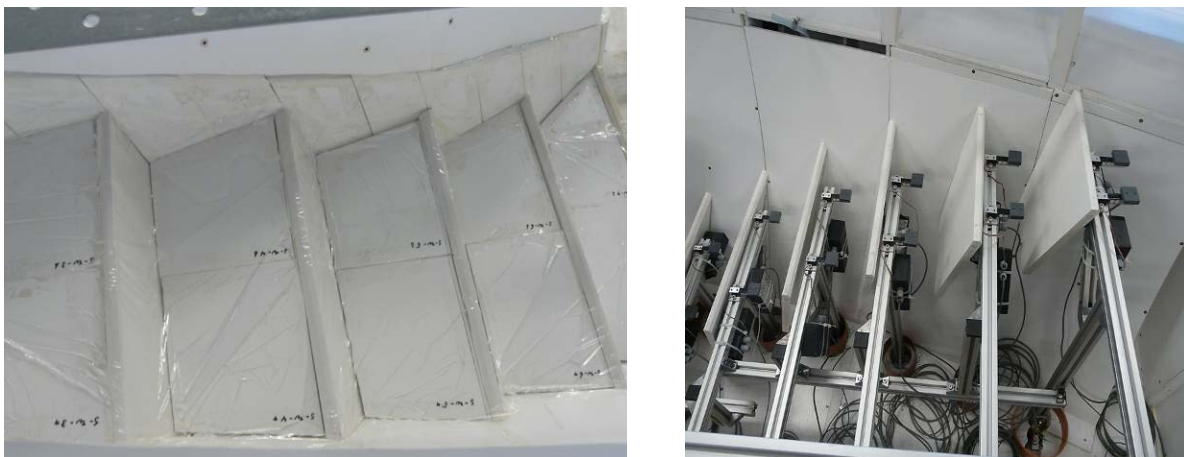
Abbildung 4: links: Aufteilung Sohle und Wange in Partialflächen, rechts: Anordnung auf westlicher Kaskadentreppe für die Aufnahme der Sohlplattenelemente
