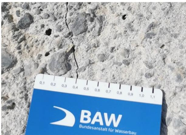
Abbildung 7: Bestimmung der Rissbreite mit einem Risslineal
