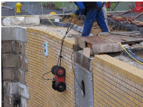
Abbildung 12: Abseilen des 400 MHz Sensors, Schleuse Kiel-Holtenau (Foto IGP, Karlsruhe)
