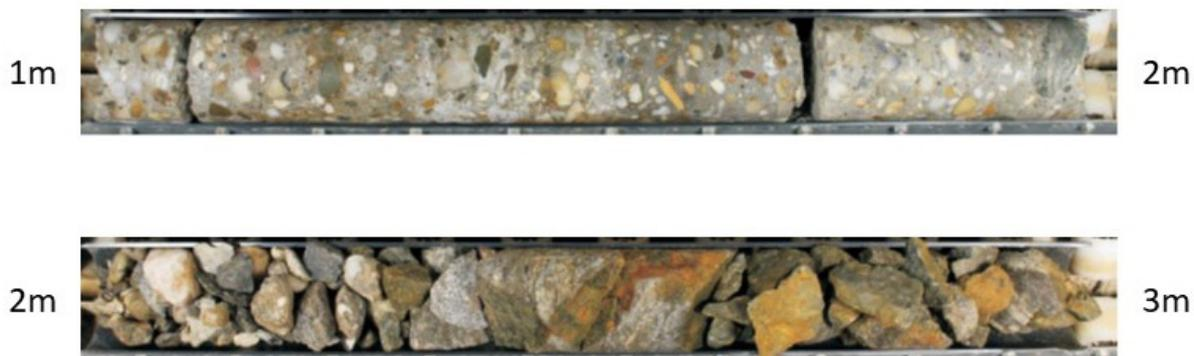
Abbildung 36: Bohrkernaufnahme für den Detailabschnitt von 1 m bis 3 m Bohrtiefe
