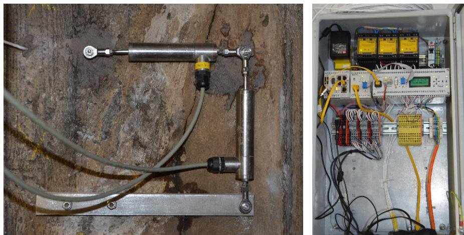
Abbildung 10: Wegsensoren und Datenlogger zur Messung horizontaler und vertikaler Rissbewegungen an der Wehranlage Geesthacht
