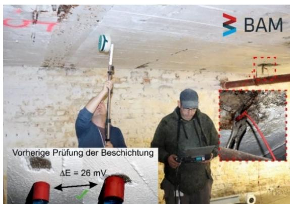
Abbildung 17: Durchführung einer Potentialfeldmessung an einer beschichteten Parkhausdecke durch die BAM mit Prüfung der Leitfähigkeit der Beschichtung und Anschluss der Messelektrode an die Bewehrung (Foto BAM)
