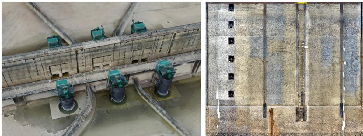
Abbildung 39: *Beispielhaftes texturiertes Modell (links) und Orthophotomosaik (rechts) eines Kammerabschnittes der Schiffsschleusenanlage Sülfeld Nord (BAW 2023b)*
