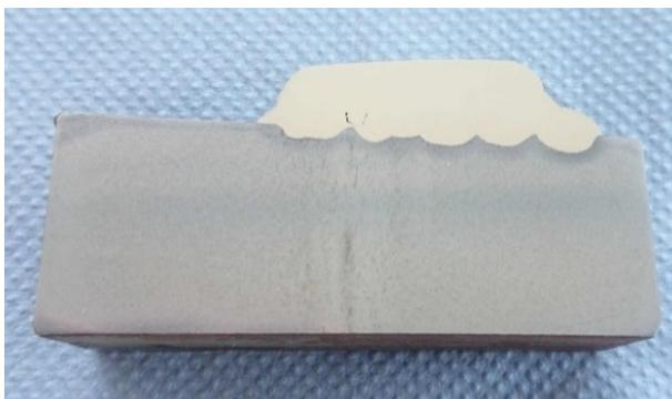
Abbildung 26: Makroschliff einer Auftragsschweißung
