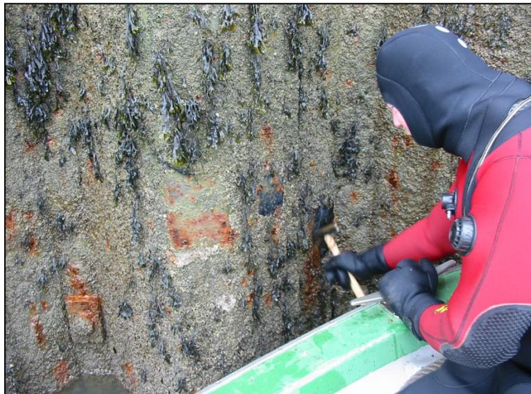
Abbildung 10: Hammerschlag-Methode
