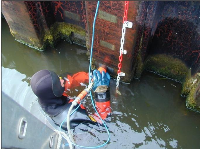
Abbildung 16: Spundwanddickenmessung mit Messkette
