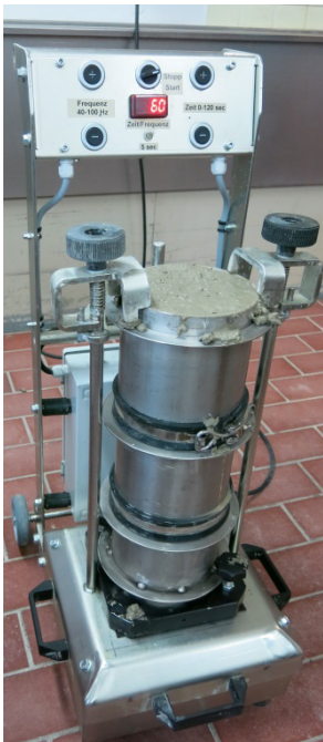
Abbildung 3: Verdichtungsgerät mit eingespannter, mit Beton gefüllter Zylinderform
