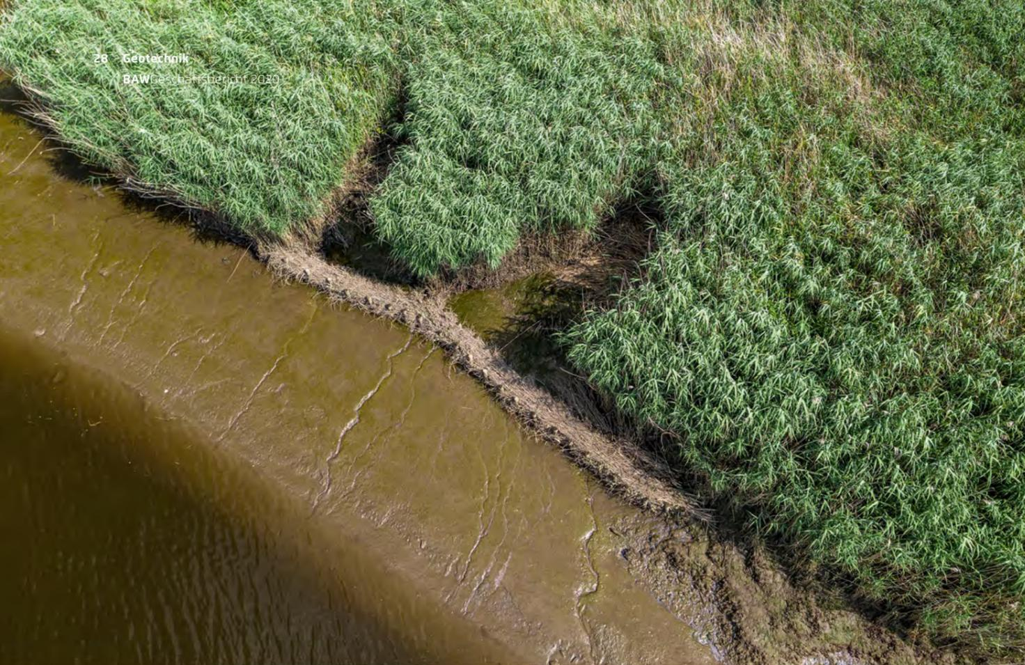
Bild 4: Untersuchung von Buschkisten und Totholzspreitlagen an der Wümme
