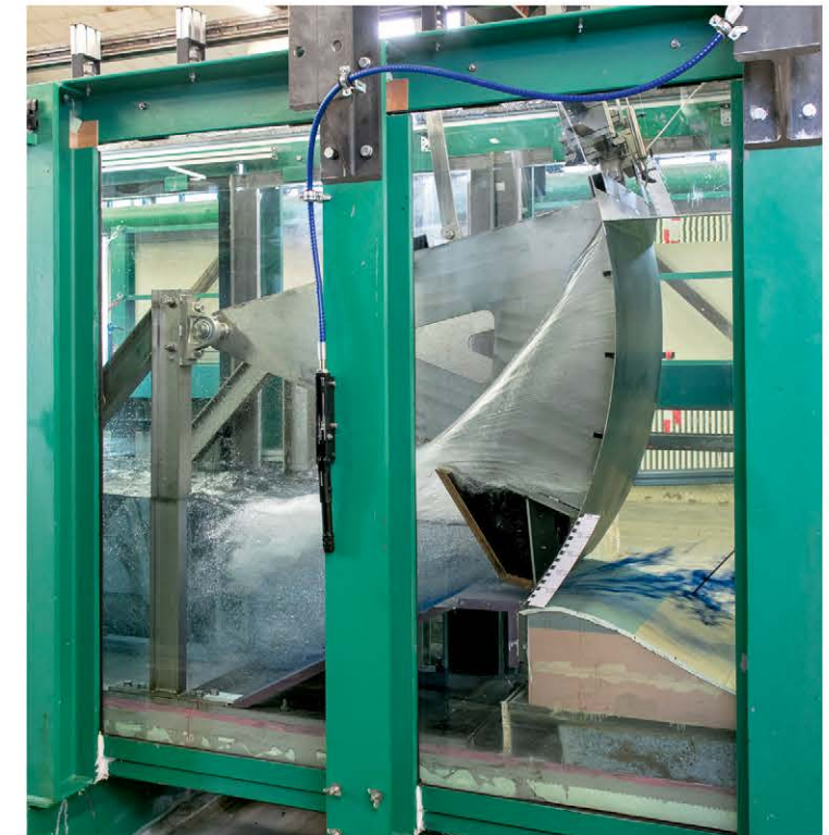
Bild 9: Versuchsaufbau mit schwingendem Drucksegment
