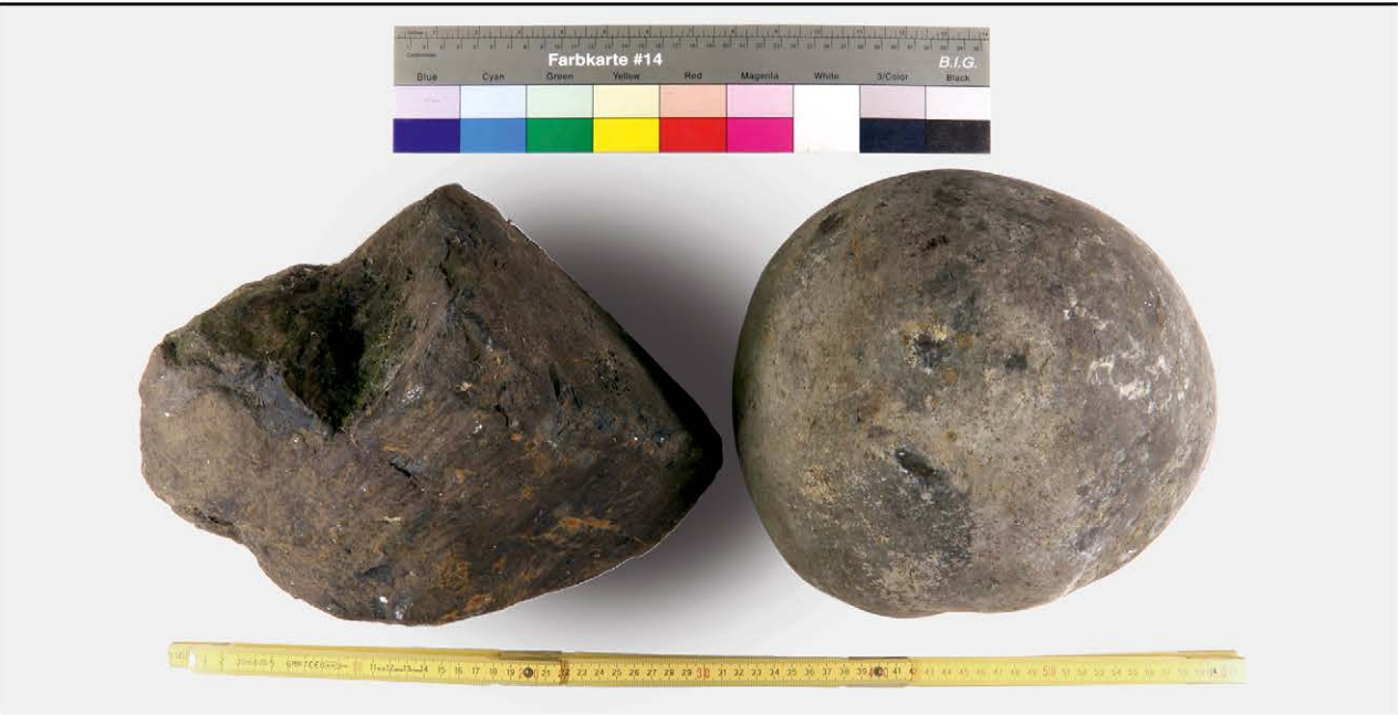
Bild 2: Wasserbausteine aus der Kolk sicherungsstrecke und aus dem Tosbecken
