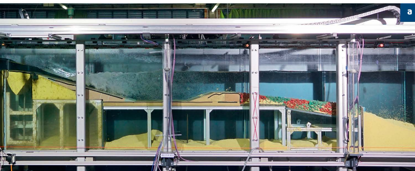
Bild 7: Laboruntersuchung für eine Tosbeckenvariante in Abhängigkeit vom Unterwasserstand: a) NHN + 1.0 m; b) NHN + 0.5 m; c) NHN + 0.0 m; d) NHN - 0.5 m und e) NHN - 1.0 m
