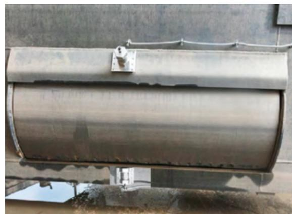
Bild 4: Platzierung des Beschleunigungsaufnehmers für die Schwingungsmessungen
