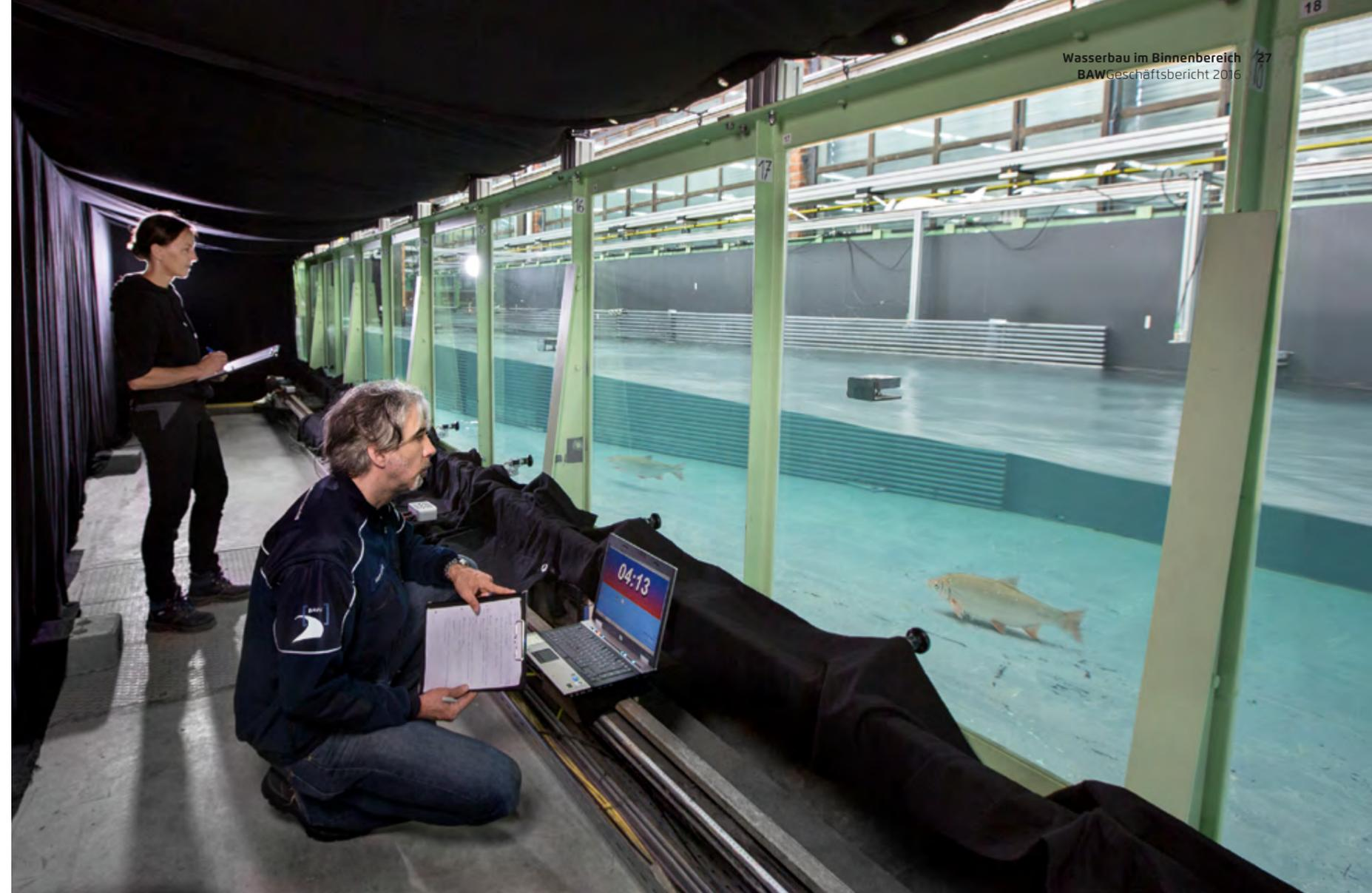
Bild 3: Blick vom Beobachtungsstand in die 2,5 m breite Ethohydraulik-Laborrinne in der BAW Karlsruhe; Versuch mit Nasen, Fließrichtung von links nach rechts, Versuchsanordnung „langer Rechen“
