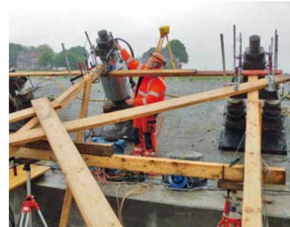
Bild 7: Probelastung der Düsenstrahlpfähle
