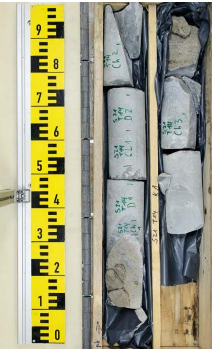
Bild 6: Kernprobe aus dem Randbereich einer Düsenstrahlsäule
