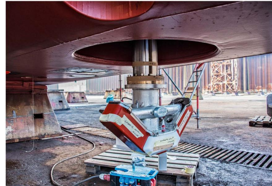
Bild 4: Unterwasseransicht auf ausgefahrenes Fächerecholot
