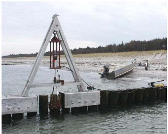
Abb. 1: Zugversuchseinrichtung an der zur Ermittlung von Pfahlwiderständen
