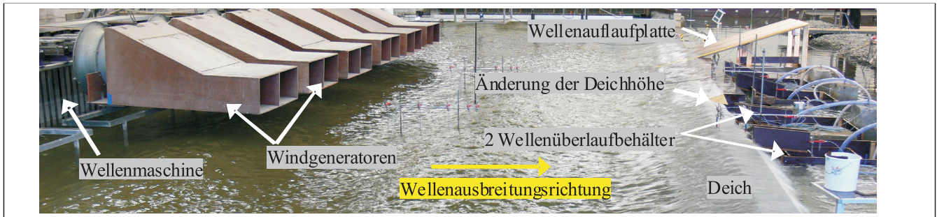
Abbildung 1: Versuchsaufbau, 1:3 geneigter Deich
