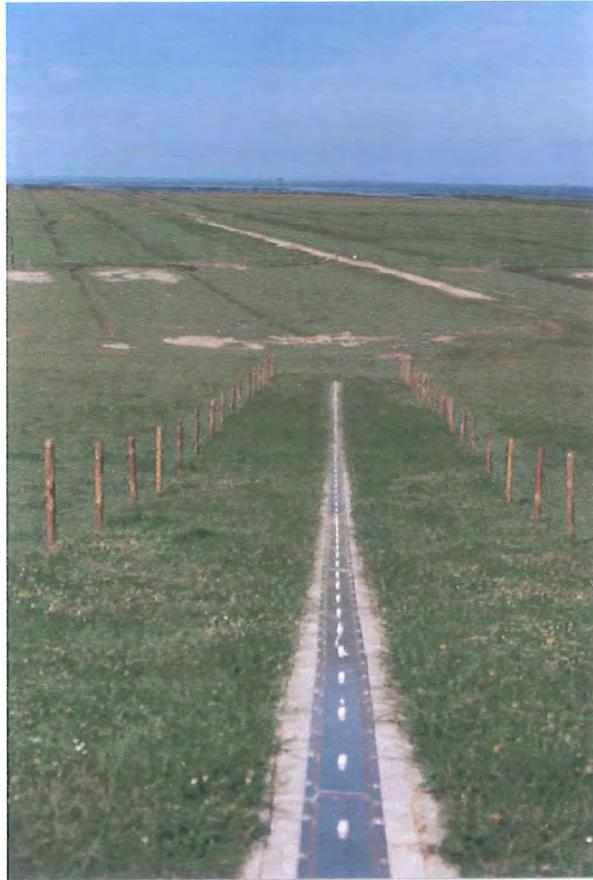
Abb. 19 Wellenauflaufpegel der Messkette Heringssand
