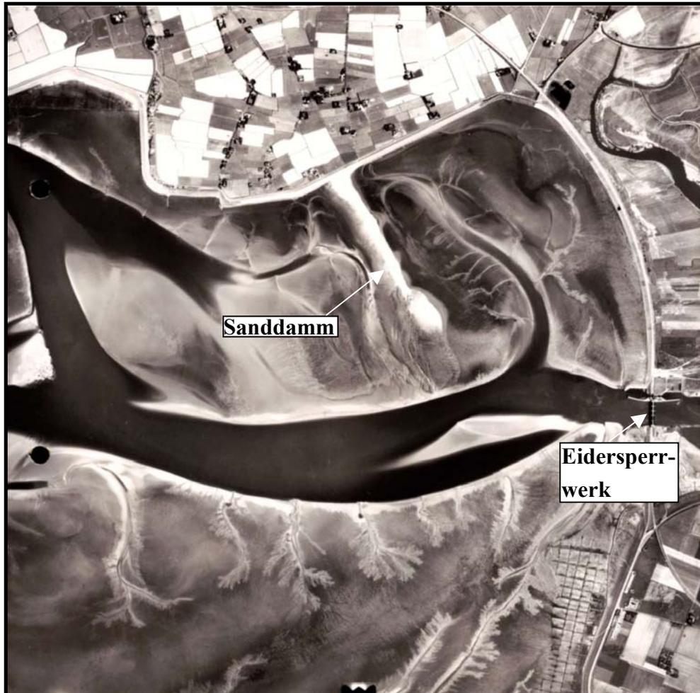
Abb. 3.13: Luftbild der Außeneider im Jahr 1986 mit dem Sanddamm und dem Eidersperrwerk.
