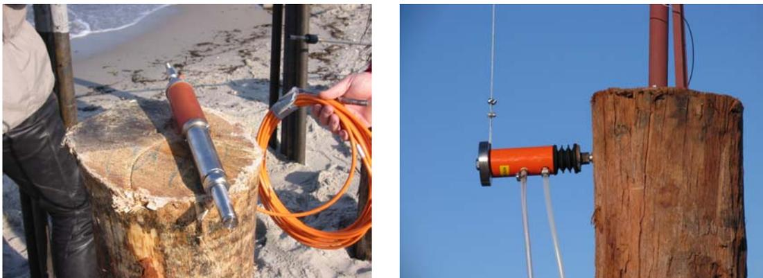
Abb. 64: Drucksensor mit Gummipacker und Anschlusskabel / Pneumatischer Kolbenvibrator
