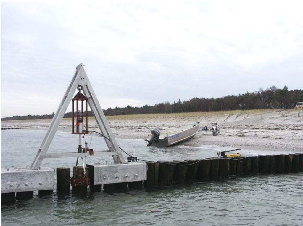
Abb. 52: Zugmaschine zur Messung von Pfahl-Haltekräften
