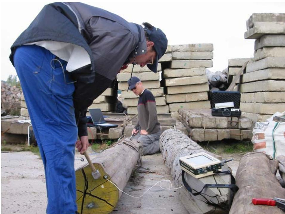
Abb. 58: Mitarbeiter der BAM bei der Durchführung von Low-Strain-Integritätstests an Holzpfählen auf dem Gelände der Fa. Brännich / Kühlungsborn.
