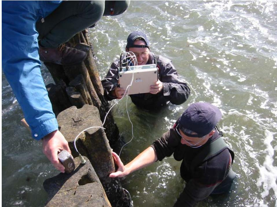
Abb. 59: Durchführung von Low-Strain-Versuchen an Bühnenpfählen vor Warnemünde.
