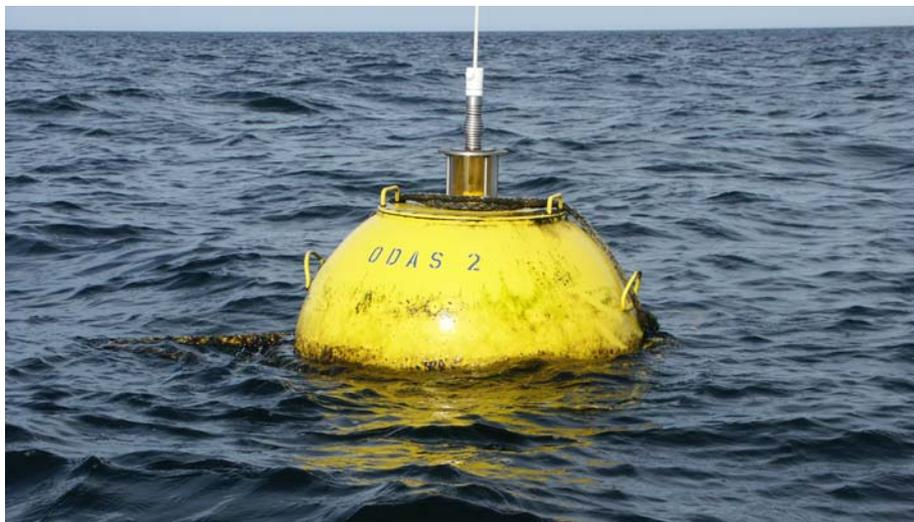
Abb. 5 :Richtungswellenmessboje Directional Waverider vor Heiligendamm
