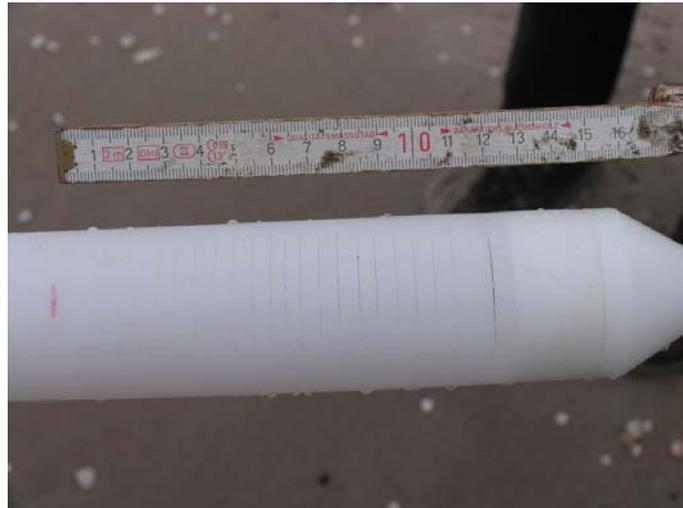
Abb. 67: HDPE Schlitzfilter
