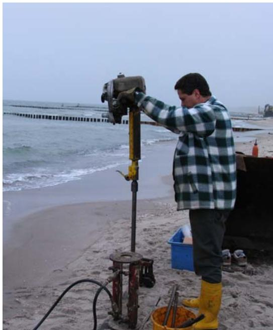
Abb. 48: Rammkernsondierung am Strand von Zingst
