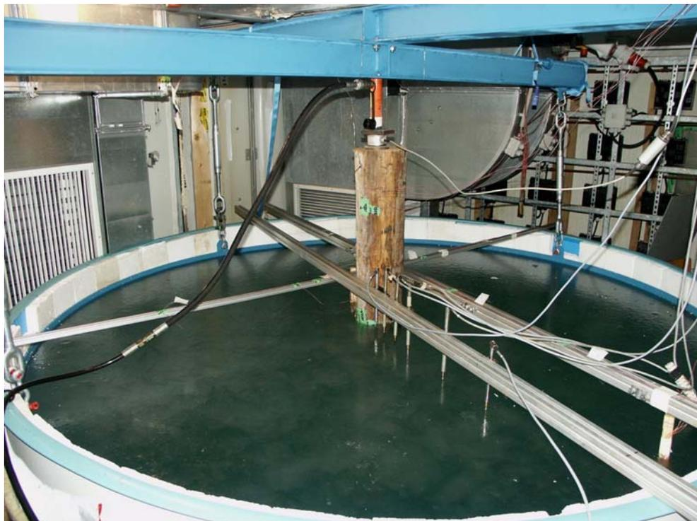
Abb. 35: Versuchsanlage zur Bestimmung vertikaler Eislasten
