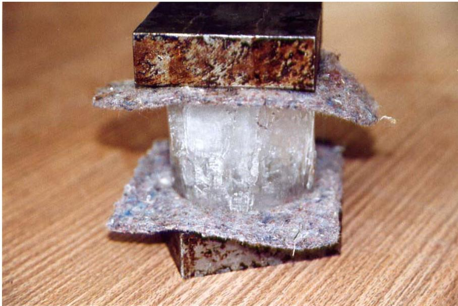
Abb. 39: Eisprobe nach Versuchsdurchführung, Geotextil und Stahlplatten gewährleisteten einen gleichmäßigen Eintrag der Kraft in die Stirnflächen des Probezylinders
