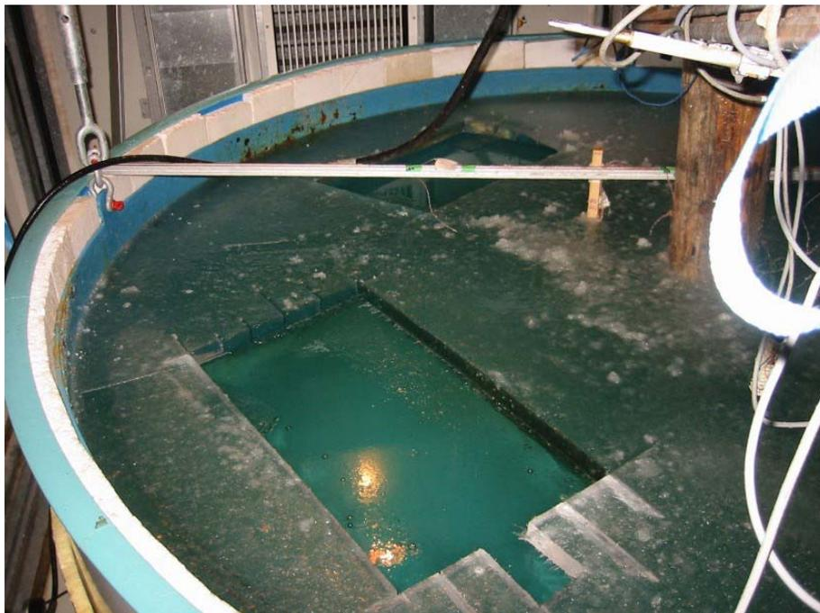
Abb. 38: Entnahme von Eisproben (Balken) für Biegezugfestigkeit nach DIN 53452 (Bruchspannung aus einer Biegeprüfung mit 3 und 4-Punkt-Auflage)
