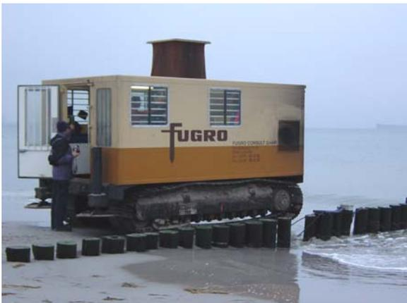
Abb. 43 Drucksondierungsfahrzeug
