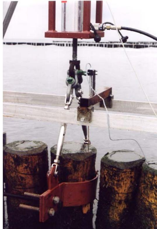
Abb. 54: Detail Zugeinrichtung (Zugzylinder,
