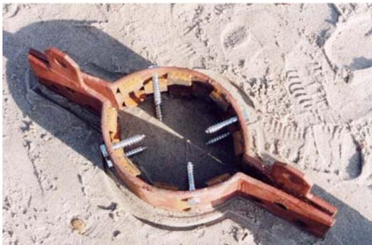
Abb. 53 Schelle zur Kraftübertragung
