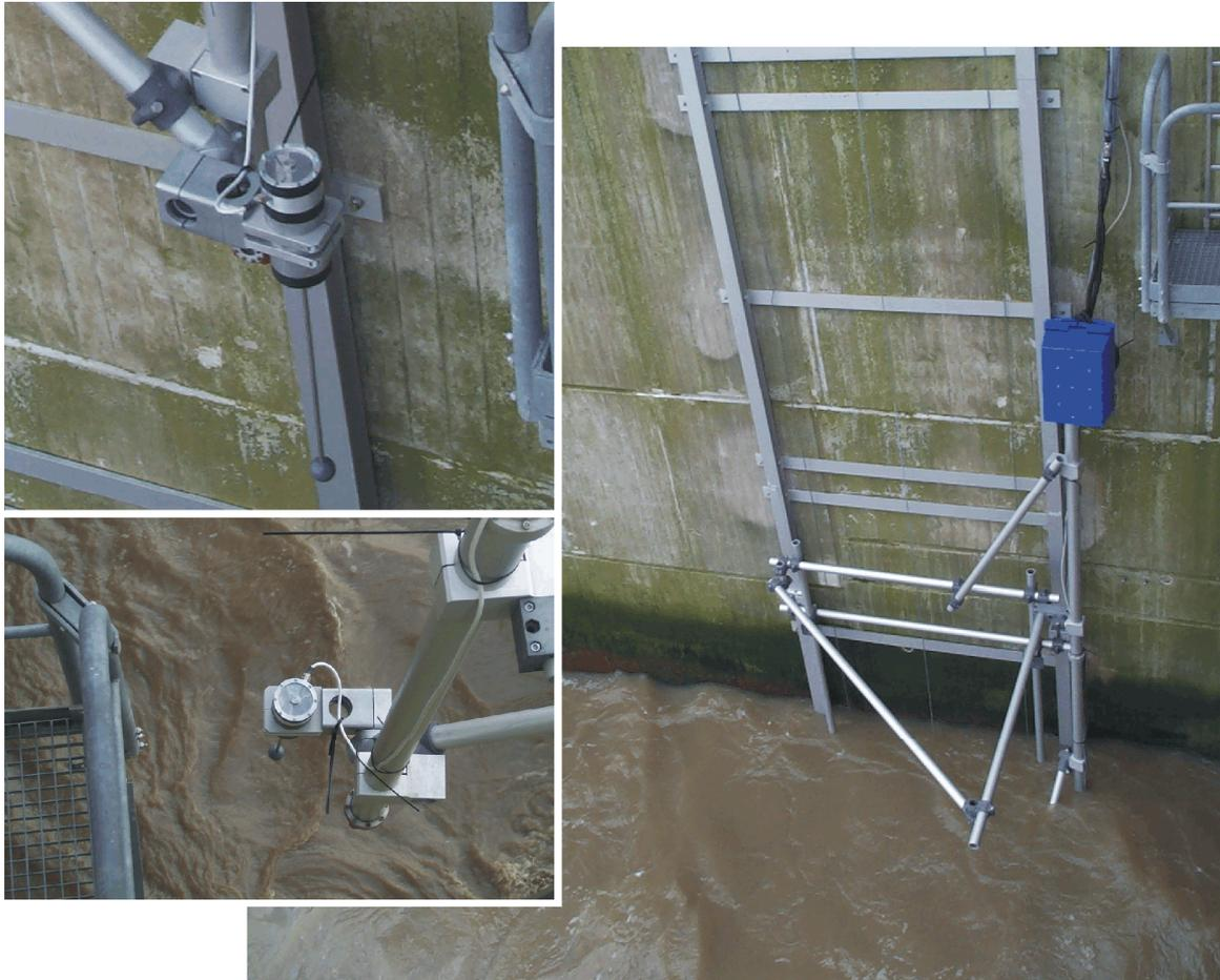
Abb. 5-8: Anströmkörper-Strömungsmesssystem am Emssperwerk
