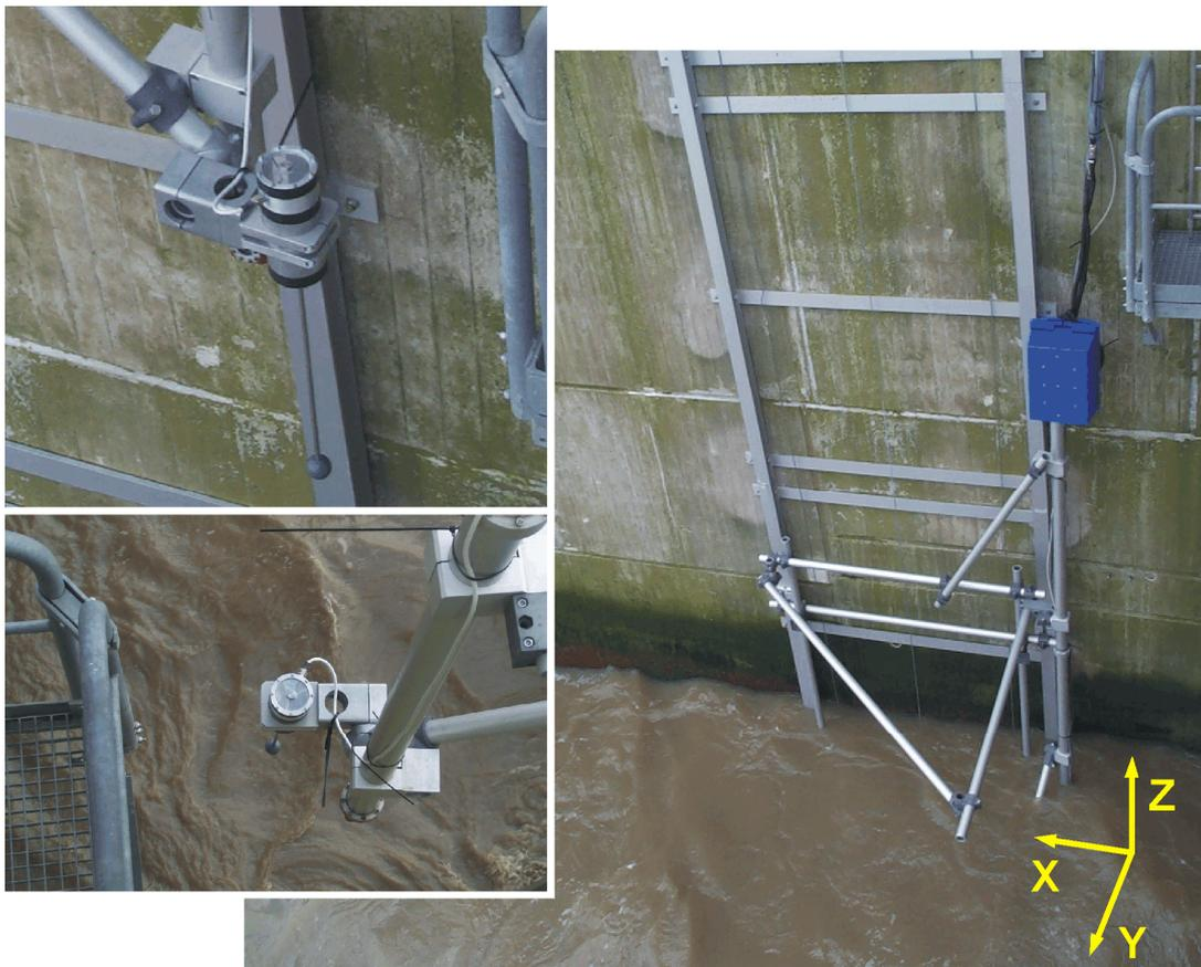
Abb. 4-1: Anströmkörper-Strömungsmesssystem am Emssperrwerk
