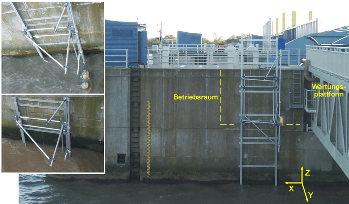
Abb. 3-4: 3D-Strömungsmesssystem am Emssperwerk
