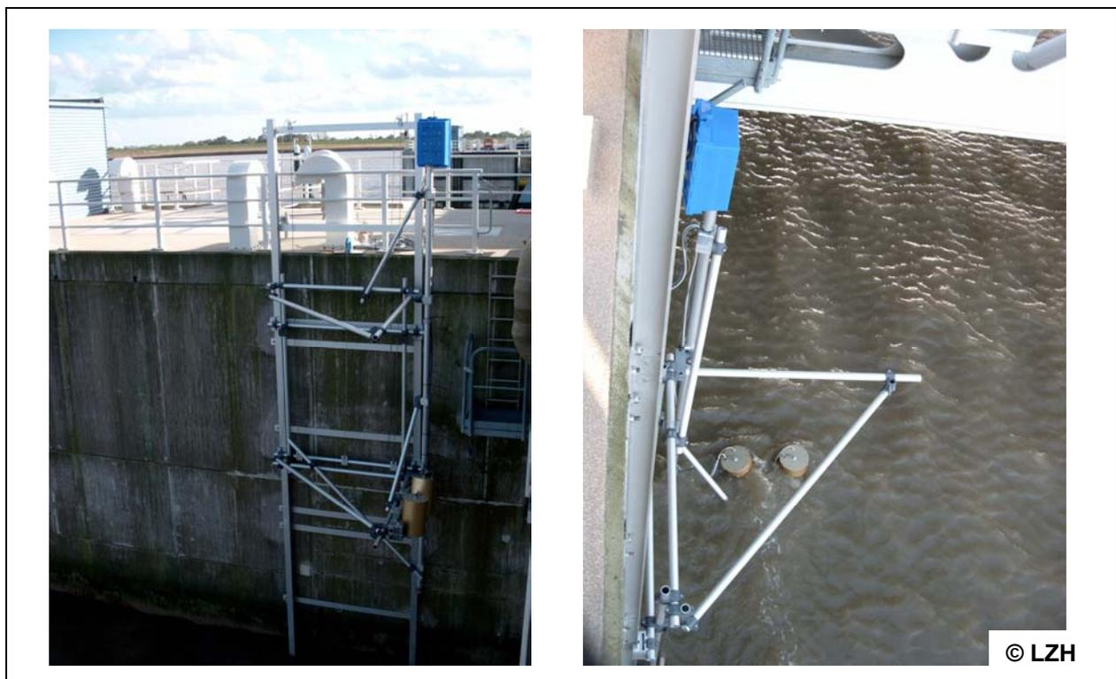
Abb. 5-15: Messaufbau am Emssperrwerk; Trägersystem mit PIV-Messsystem
