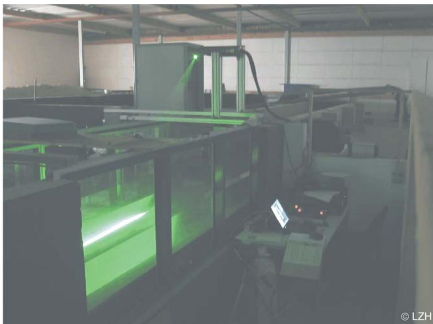
Abb. 5-8: Umlaufrinne; modifizierter Aufbau des PIV-Systems
