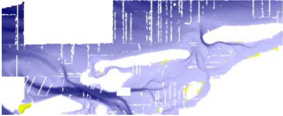
Abbildung 4-26 Bathymetriesimulation für das Jahr 1998 (lineare Interpolation)
