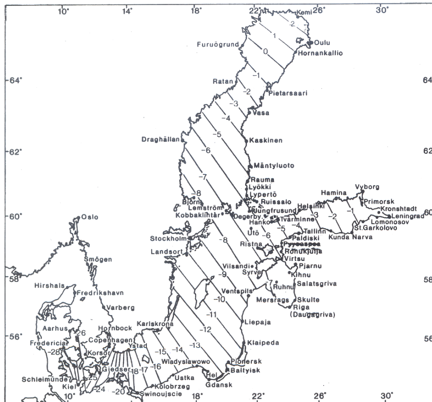
Abbildung 4.11: Mittlere Neigung der Meeresoberfläche der Ostsee, dargestellt durch Linien gleicher mittlerer Abweichung vom Mittelwasser von Kronstadt im Baltic Levelling Polygon in der Periode 1951-1976 (HUPFER ET AL. 2003)
