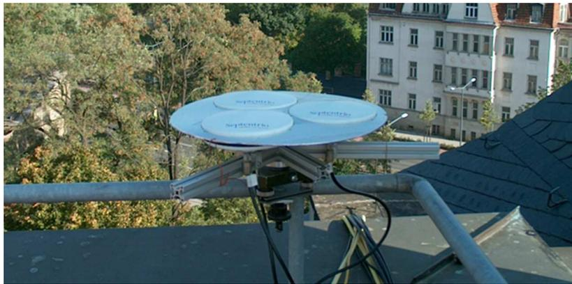
**Abb. 2-8:** Entwickelter Antennenprototyp zur Verringerung des Mehrwegeinflusses auf Referenzstationen.
