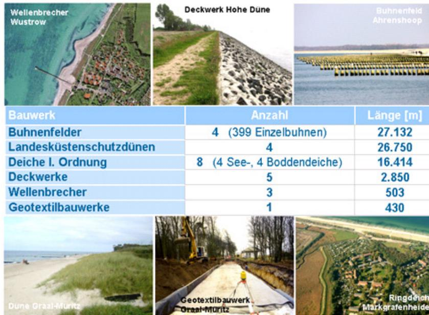
**Abbildung 12** Art der bestehenden Küstenschutzanlagen im Bereich Rostock bis zum Darß
