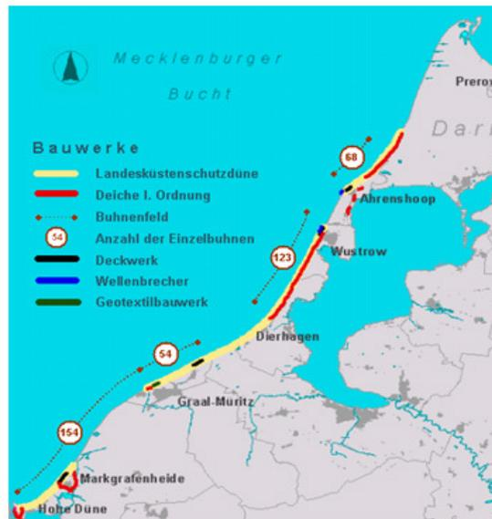
**Abbildung 13** Verteilung der Küstenschutzanlagen aus Abbildung 12 im Projektgebiet
