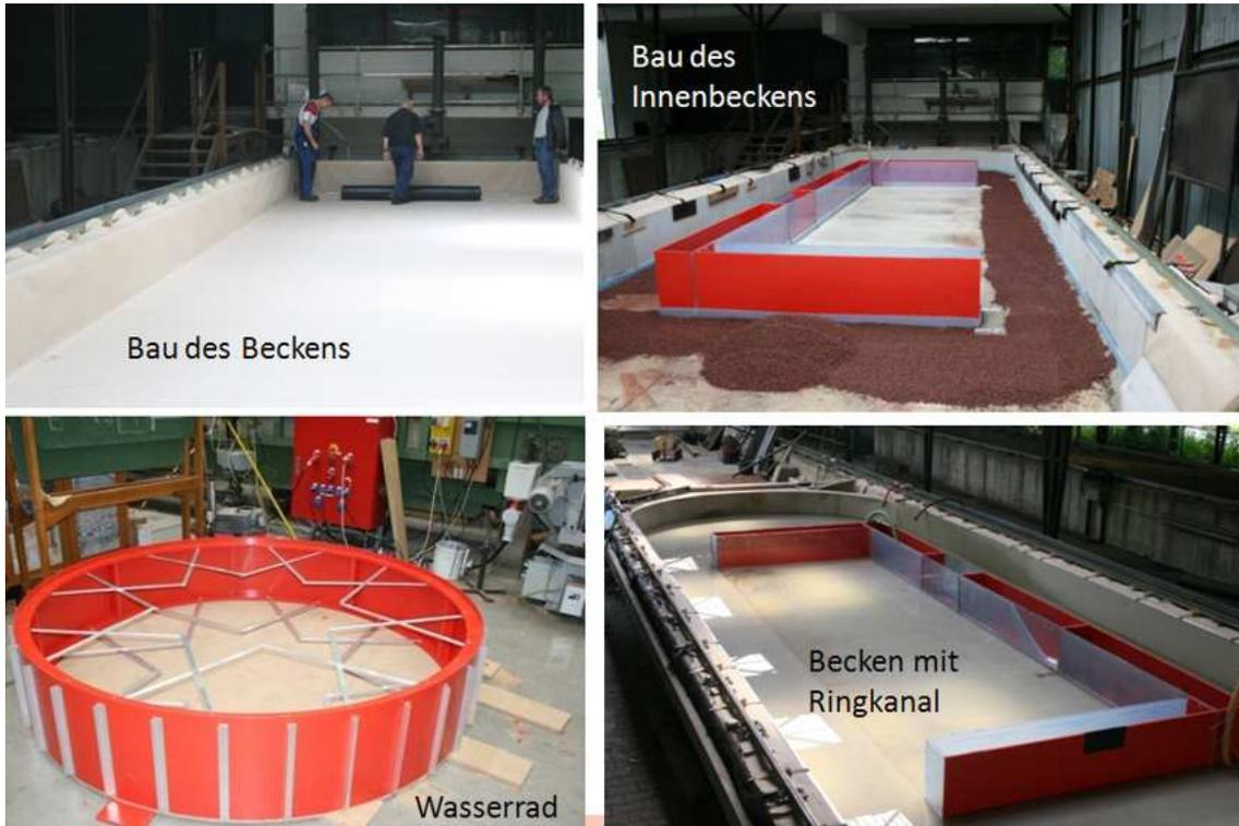
Abbildung 7.4: Bau des Modells
