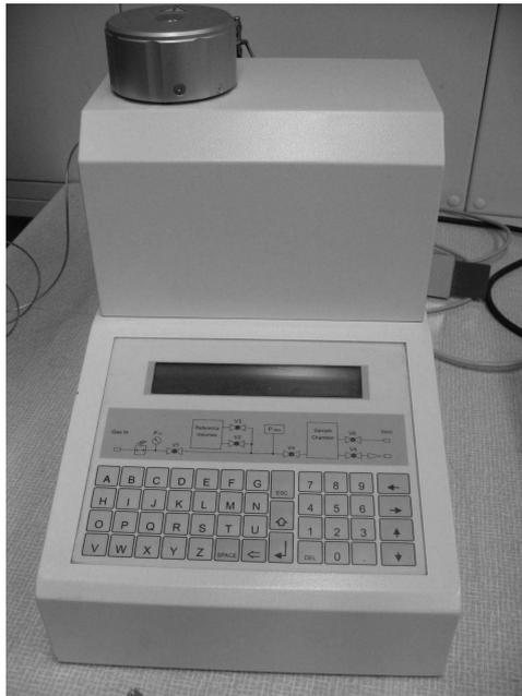
Abbildung 4.22: Ansicht des Pycnometers Pycnomatic ATC.
