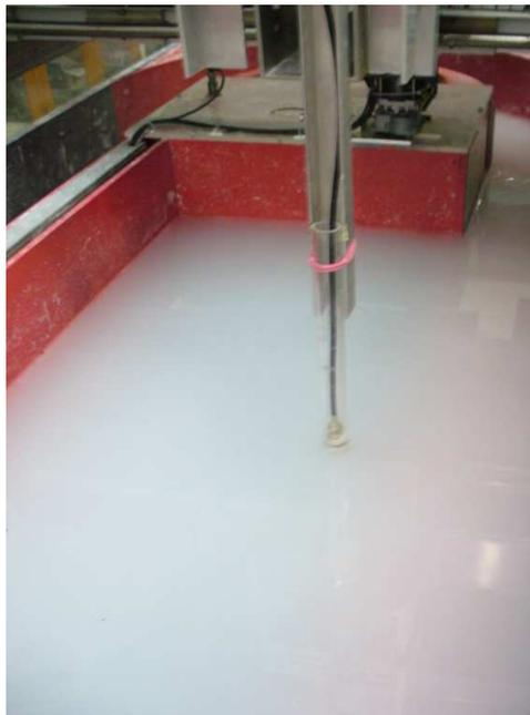
Abbildung 7.8: Ultraschallsonde F05 im Einsatz.
