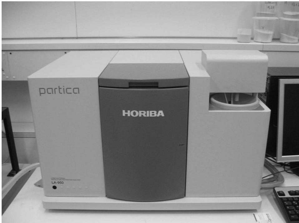
Abbildung 4.16: Ansicht des Partikelsizers HORIBA LA-950
