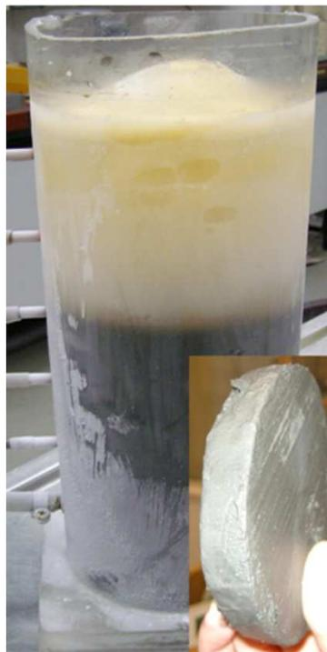
Abbildung 7.19: Gefrorene Schlickprobe im Messzylinder.
