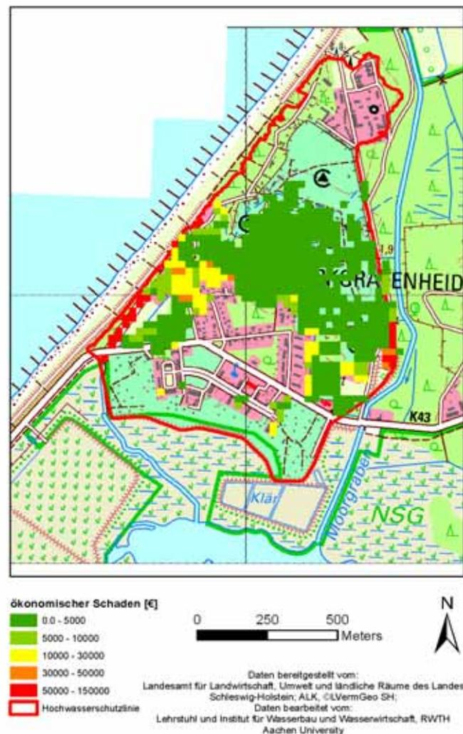
Abb. 8.22: Ökonomischer Schaden der Analyse der Konsequenzen des  $SE_{F1c100}$  (CA\_1-0\_2-0)
