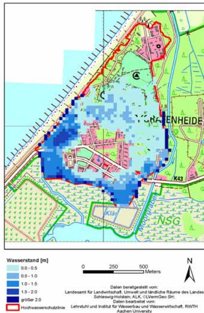
Abb. 8.21: Ergebnisse der hydrodynamischen Analyse des  $SE_{F1c100}$  (CA\_1-0\_2-0)
