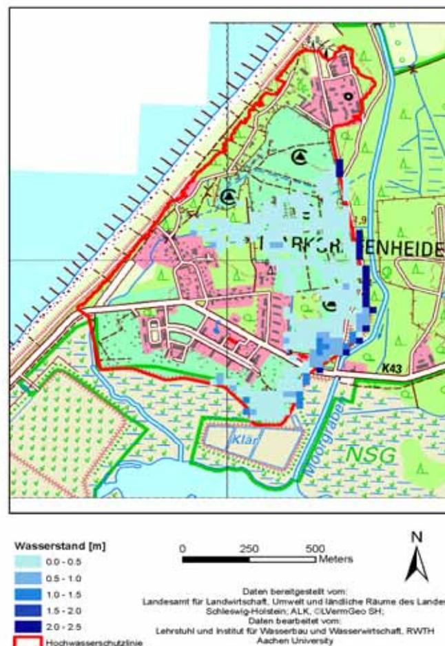
Abb. 8.13: Ergebnisse der hydrodynamischen Analyse des  $SE_{F1a10000}$  für das Versagensereignis CA\_4-0
