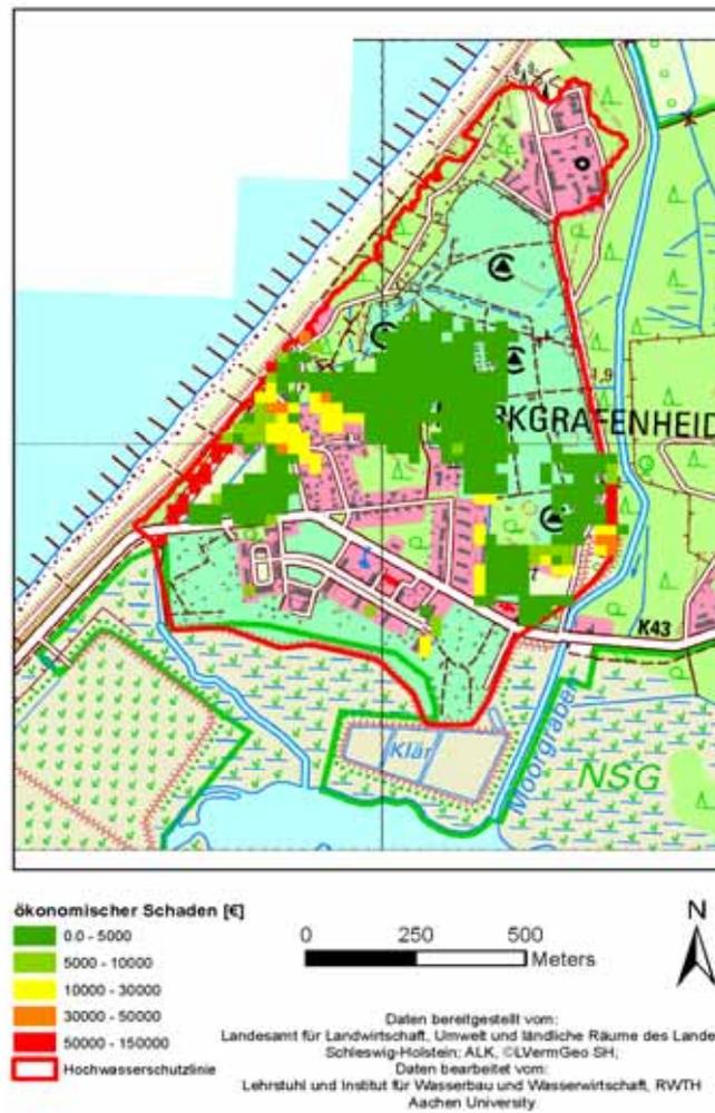
Abb. 8.18: Ökonomischer Schaden der Analyse der Konsequenzen des  $SE_{F1a1000}$  (CA\_4-0)
