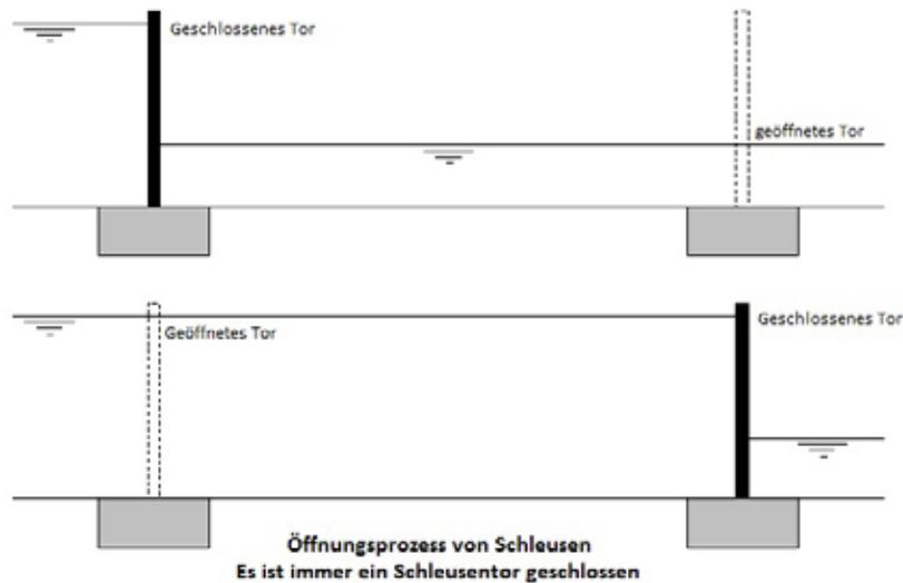
Abb. 3.19: Veranschaulichung der Schleusenpositionen beim Öffnungsprozess einer Schleuse (nach Allsop et al. (2007))
