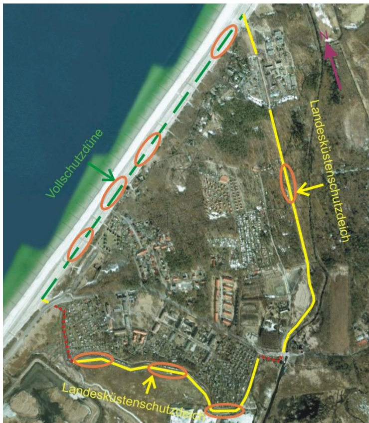
Abb. 19: Versagenslokalationen entlang der Hochwasserschutzanlagen
