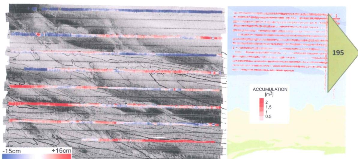
Abb. 8. Einfluss von Einzelereignissen (am Beispiel 31.03.2012) auf die Morphologie der Zungenriffe im Seitensichtsonarbild – überlagert sind Volumendifferenzen (Erosion in blau, Akkumulation in Rot).
