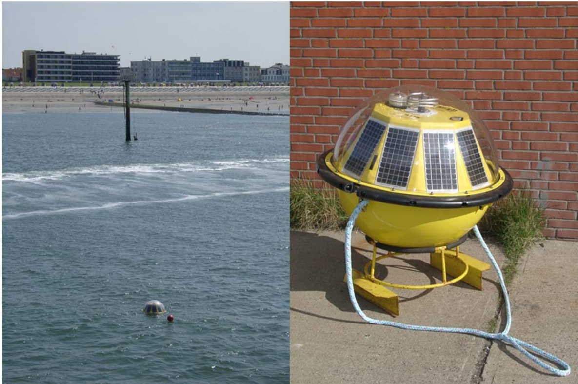
Abbildung 2: TRIAXYS Boje bei Testlauf vor Norderney (links) und in der Nahaufnahme (rechts)
