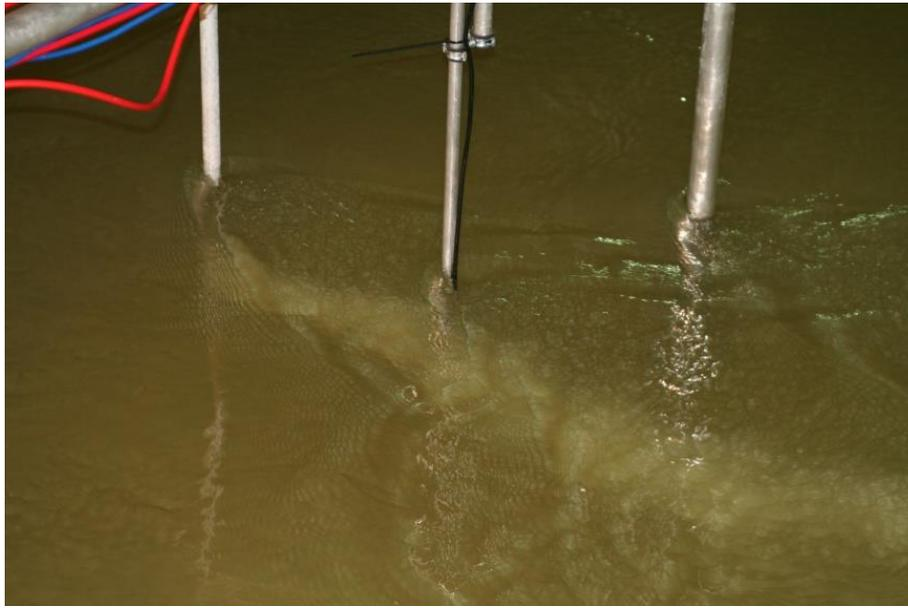
Abb. 5.22: Injektionslanze mit Haltestange bei Strömungsversuchen (Lieske 2015)
