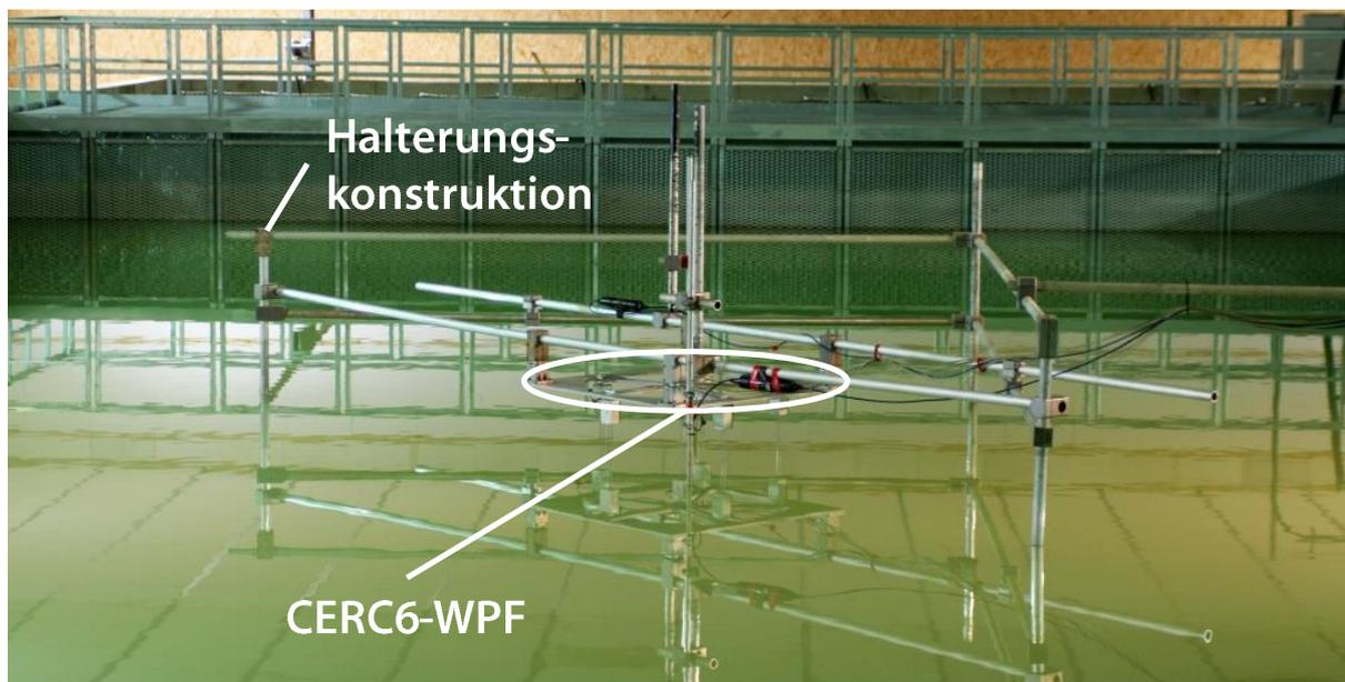
Abb. 4.22: Haltekonstruktion des CERC6-Wellenpegelfeldes im Untersuchungsgebiet
