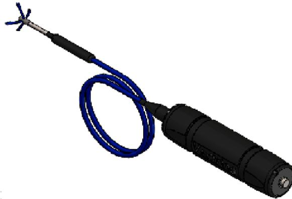
Abb. 4.8: ADV-Sonde vom Typ Vectrino Plus und Profiler (Nortek AS 2012)
