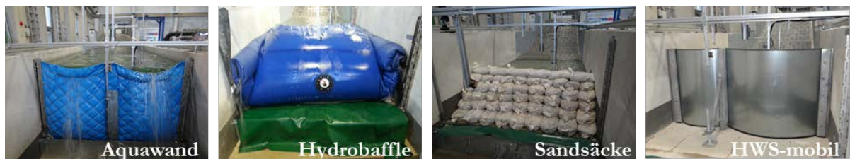
Abbildung 2: Im Labor getestete mobile Hochwasser- bzw. Küstenschutzmaßnahmen.
