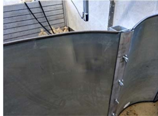
Abbildung 4-2: Auslenkung der Mittelstütze infolge Treibgutprall an der Maßnahme HWS-mobil (ohne zusätzliche Abstützung) und Verformungen am Stahlblech nach Abschluss der Anprallversuche.
