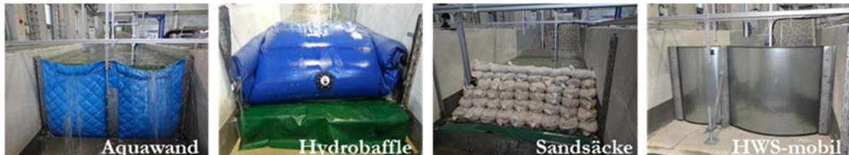
Abbildung 2-3: Untersuchte mobile Hochwasser- bzw. Küstenschutzmaßnahmen während der Testphase in der wasserbaulichen Versuchshalle.
