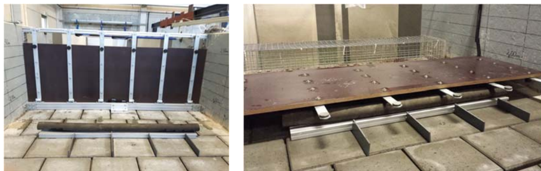
Abbildung 3-4: Wellenklappe in geschlossenem (links) und geöffnetem (rechts) Zustand.
