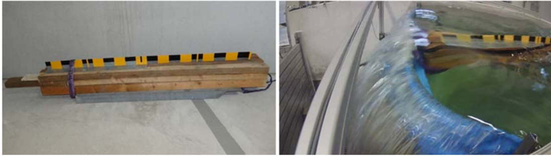
Abbildung 3-10: Anprallkörper (links) und Anprallversuch an der Aquamwand (rechts).
