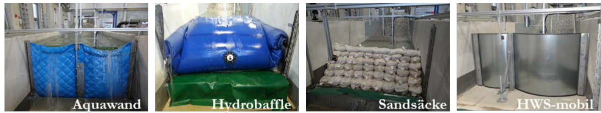
Abbildung 1: Im Labor getestete mobile Hochwasser- bzw. Küstenschutzmaßnahmen.
