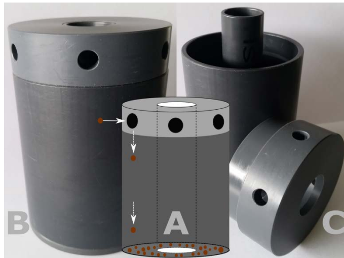
Abbildung 4: Sedimentsammler nach Manzenrieder & Partner (nach Hache et al. 2019). A: Skizze des Sammlers mit innerem Prallrohr (gestrichelt), B: geschlossener Sammler, C: geöffneter Sammler
