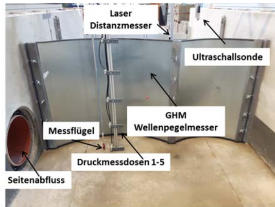
Abbildung 3-5: Anordnung der Messgeräte.
