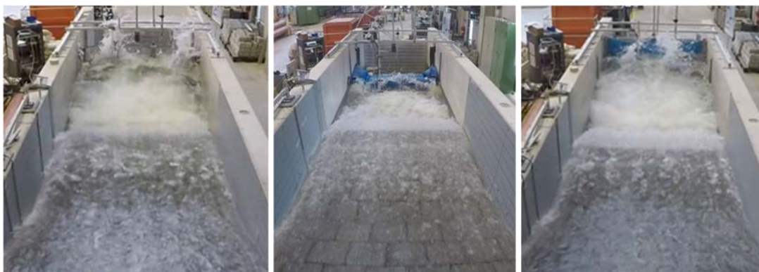
Abbildung 3-9: Testphase 4 – Wellenanprall auf HWS-mobil , Hydrobaffle und Aquawand .
