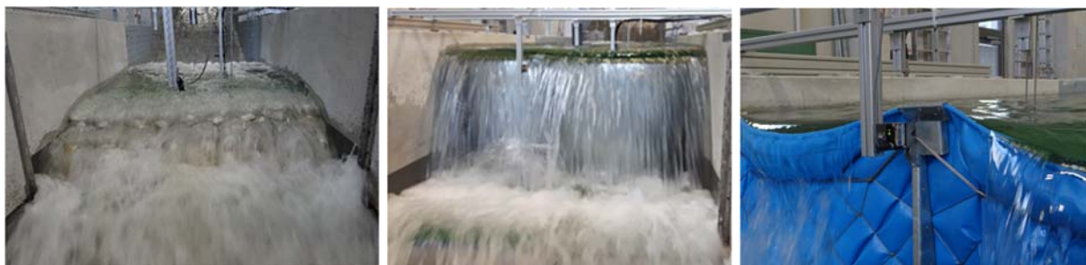
Abbildung 3-8: Testphase 3 – Überströmen von Sandsackdeich , HWS-mobil und Aquawand .
