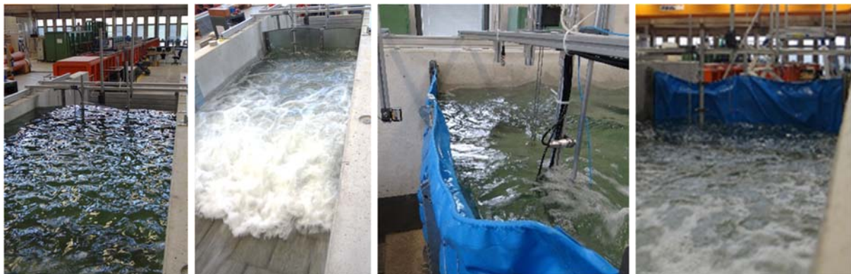
Abbildung 3-7: Testphase 1 und 2 – Einstau und Anströmen an HWS-mobil und Aquawand .
