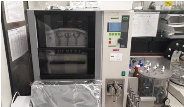
Abbildung 2.27: Pressurized Liquid Extraction System (PLE) (Büchi Labortechnik GMBH).
