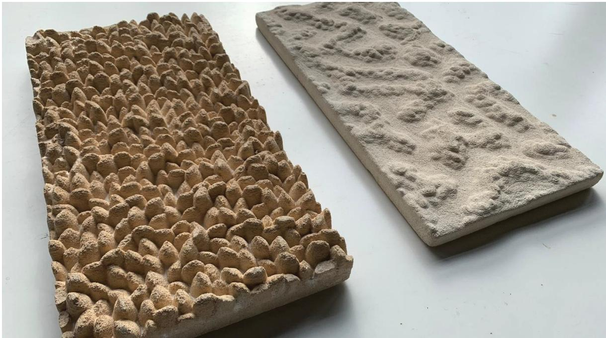
Abbildung 3: Gedruckte Ersatzmodellkacheln (0,25 x 0,5 m) Links: Austernriffersatzmodell; rechts: Miesmuschelbankersatzmodell.
