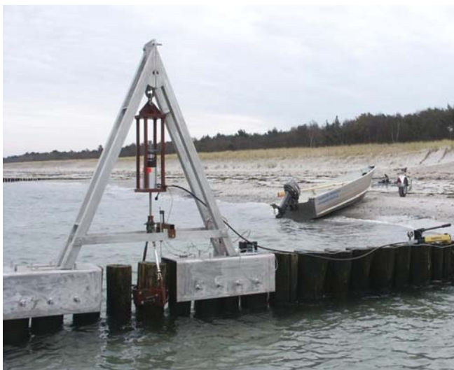
Abb. 1: Zugversuchseinrichtung an der zur Ermittlung von Pfahlwiderständen
