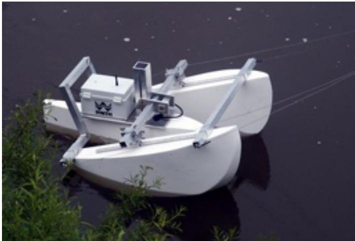
Abb. 7: Am IWW entwickelter Measure Cat Katamaran als Träger eines ADCP für Geschwindigkeits- und Abflussmessungen in Situ
