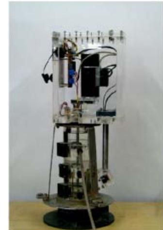
Abb. 8: Aufbau des am IWW entwickelten Erosionsmessgerätes Erosimess
