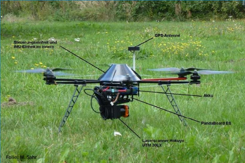
Steuerungseinheit und IMU-Einheit im Innern
