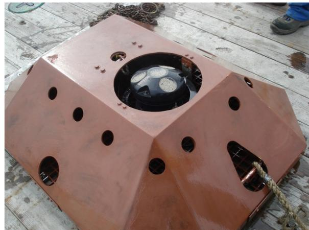
**AWAC-Messgerät im Schutzkasten**
